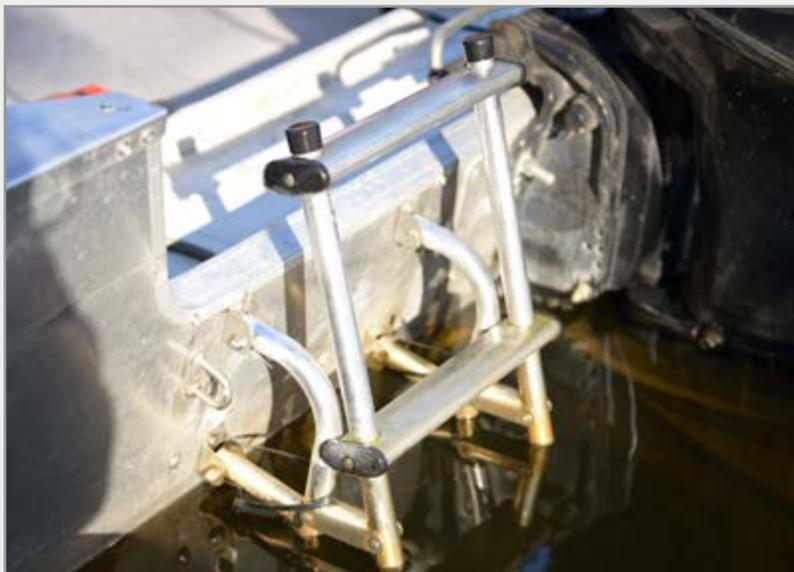
Un dispositif de remontée à bord permet à une personne se trouvant dans l'eau de remonter dans l'embarcation. Une échelle de traverse ou une échelle de plate-forme de baignade satisfont à cette exigence.
