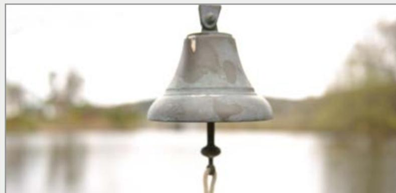
Toutes les embarcations de 12 m (39 pi 4 po) ou plus doivent être équipées d'un sifflet fixe. Les embarcations de plus de 20 m (65 pi 7 po) doivent également être équipées d'une cloche. Consultez l'Annexe III du *Règlement sur les abordages* pour connaître les normes techniques applicables à ces appareils.
